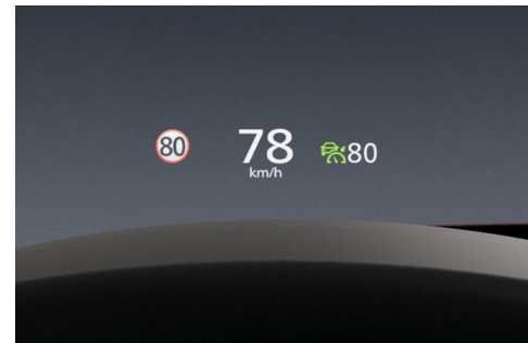
Проекционен дисплей върху стъклото пред погледа на водача HUD
