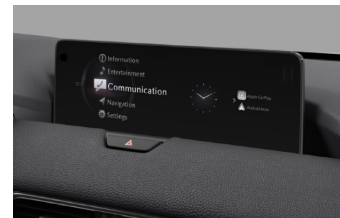
12,3" TFT цветен централен дисплей със сензорно управление
